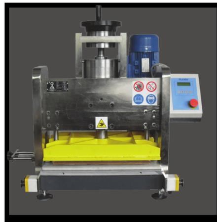
La Fustellatrice 250 formato A3 super è la più potente (fino a 25 tonnellate) e viene utilizzata per lavori gravosi, cuoio di grande spessore o cartoncino pesante o doppio. Questa macchina nasce su specifiche del cliente, ha una regolazione di posizione e di corsa di facile accesso e utilizza le soluzioni più adeguate al lavoro da un punto di vista della sicurezza (bimanuale o ripari mobili).
